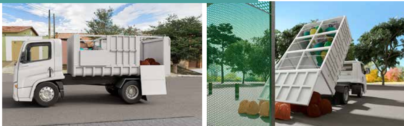
Figura 15 - Caçamba particionada adaptada para coleta simultânea de duas frações
