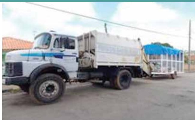
Foto 8 – Carreta simples para o transporte de resíduos orgânicos segregados, acoplada a veículo de coleta.
