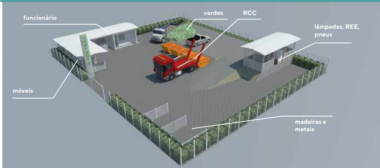
Figura 2 – Layout esquemático do Eco ponto Padrão – área entre 800 e 1.000 m 2 com operação de caminhão poliguidaste.
