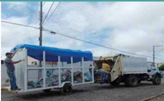
Foto 8 – Carreta simples para o transporte de resíduos orgânicos segregados, acoplada a veículo de coleta.
